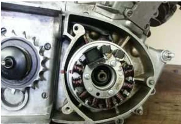
Am besten die Spule leicht runterdrücken und gleichzeitig das Kabel von hinten (Zündspulenöffnung), Stück für Stück, ziehen. Am Ende sollte die Spule mit einem hörbaren klicken aufsetzen. Wenn nicht, ist garantiert ein Kabel darunter eingeklemmt.
