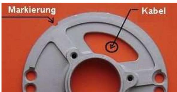
Schauen Sie sich die Stator-Grundplatte an. Dort befindet sich links von der "Kabel"-Durchführung eine kleine Kerbe ("Markierung") auf dem Außenumfang.
