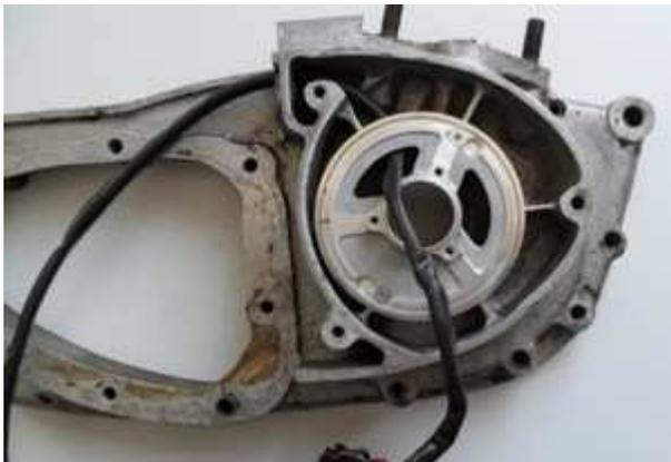
Befestigen Sie die neue Stator-Einheit (äußeren Stahl- und inneren Aluminiumring) im Motorgehäuse mit den beiden M5 Senkkopfschrauben. Die Statorspule hängt lose am Kabelbaum herunter. Es ist egal, welche Befestigungslöcher Sie benutzen, solange das Kabel durch die, wie oben beschriebene, entsprechende Öffnung geführt wird (die Öffnung neben der Kerb-Markierung).
