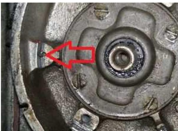
Nehmen Sie ebenfalls den kleinen Stift aus der Auflagefläche der Statorplatte im Motorgehäuse (siehe Bild). Dieser wird auch nicht mehr benötigt und stört beim Einbau der neuen Statorplatte.
