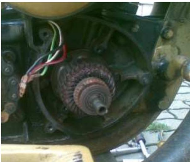
Nehmen Sie die Passfeder auf dem Konus der Kurbelwelle mit einer Zange ab. Sie wird nicht mehr benötigt. Bitte nicht vergessen, sonst müssen Sie die Lima später noch einmal herausnehmen.
