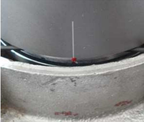
Mit dem Motor in Zündposition setzen Sie den Rotor wieder vorsichtig auf. Dabei müssen jetzt die beiden Zündmarkierung (auf Rotor und Stator-Grundplatte) übereinander stehen. Beim festziehen der Rotorschraube müssen Sie darauf achten, daß weder der Rotor noch die Kurbelwelle bewegt werden. Ansonsten ist die Zündung verstellt und Sie müssen den gesamten Vorgang der Rotorinstallation wiederholen.
