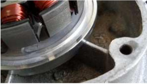
Bitte nehmen Sie auf keinen Fall mechanische Veränderungen am Motorgehäuse vor. Lassen Sie auch keinesfalls den Stahlring weg, auch wenn Sie kurzzeitig (und garantiert fälschlich) der Meinung sein sollten Sie müssten dies tun, um die Grundplatte aufzusetzen.
