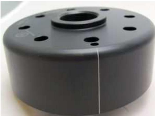
Schauen Sie sich den neuen Rotor an. Sie finden auf seinem Außenumfang eine kleine eingepreßte Linie, auch eine Zündmarkierung. Sie ist zwar dauerhaft, aber schlecht sichtbar. Es ist von Vorteil sie mit einem Textmarker (o.ä.) zu verdeutlichen.
